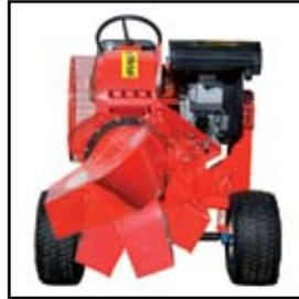
**THE OPERATOR MAY ROTATE THE DIRECTIONAL CHUTE 360 DEGREE SIMPLY BY TURNING THE ELECTRONIC SELECTOR KNOB.**
